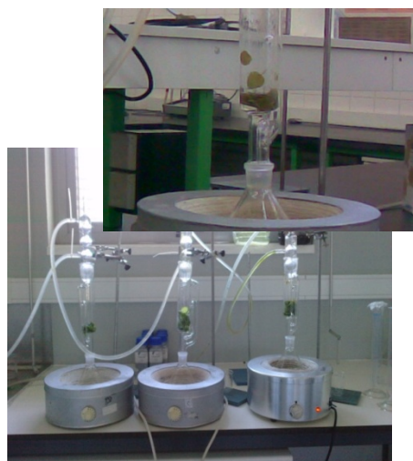
Figura 1: Perspectivas do sistema de Soxhlet , para produção de extracto de hortelã-pimenta
